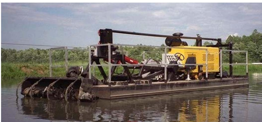
Figura 5.3 - Draga fabricada pela empresa Liquid Waste Technology Inc. (E.U.A.) operando em lagoa de estabilização
